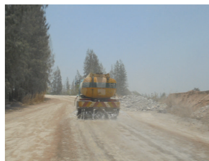
รูปที่ 2-23: การฉีดพรมน้ำบนเส้นทางขนส่งแร่
